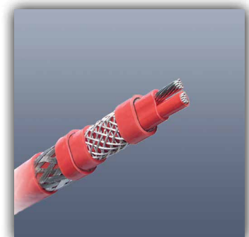
KM-HPT Temperaturhaltung bis 210°C temperature up to 210°C 15, 30, 45 & 60 W/m at 10°C Dampfspülfest steam purging
