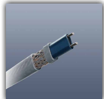
KM-KSX Temperaturhaltung bis 121°C temperature up to 121°C 15, 31, 48 & 64 W/m at 10°C
